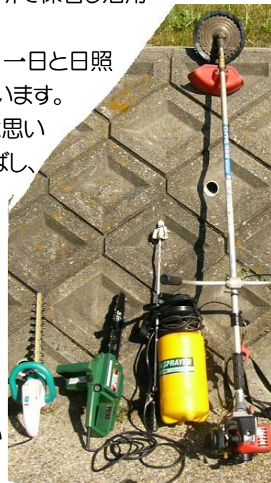
事務所保有の器具：左から電動バリカン、電動チェーンソー、薬剤散布噴霧器、草刈り払い機
